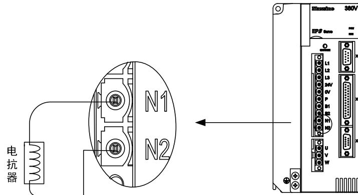
注：仅GL190、GL240、GH2A0、GH3A5、GH5A4、GH8A5、GH130、GH170、GH210型伺服驱动器有外接电抗器连接功能。
