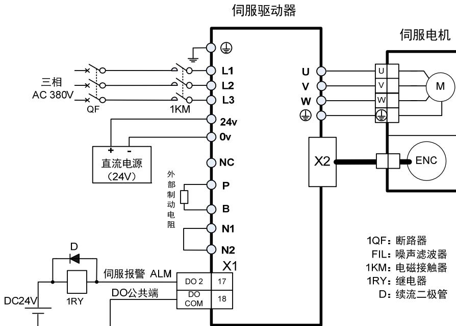
注：GH170、GH210 无内部制动电阻，需连接外部制动电阻使用。
