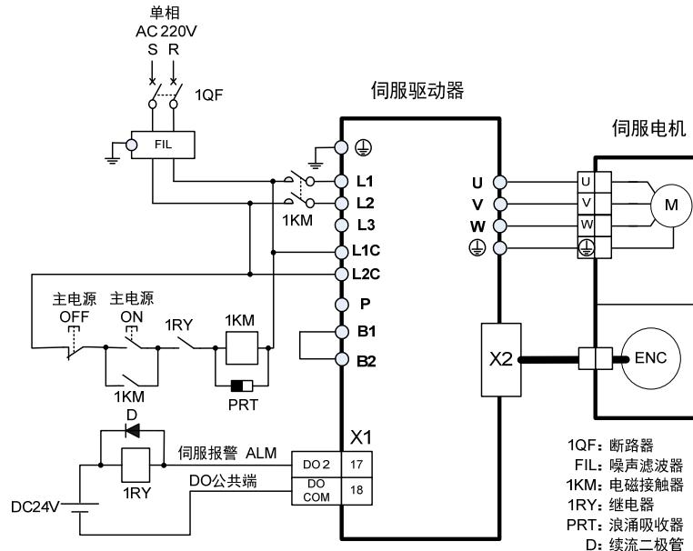
注：GL1A0 无内部制动电阻，一般不需要连接制动电阻。
