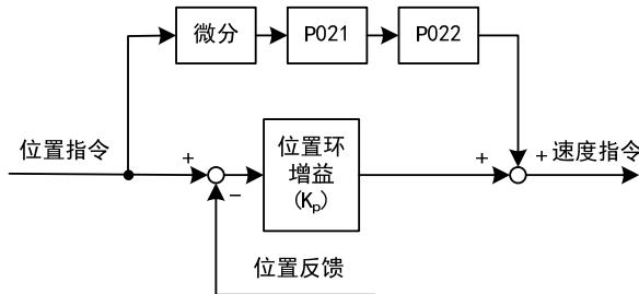
前馈能降低位置环控制的相位滞后，可减小位置控制时的位置跟踪误差以及更短的定位时间。前馈量增大，位置控制跟踪误差减小，但过大会使系统不稳定、超调。若电子齿轮比大于10也容易产生噪声。一般应用可设置P021为0%，需要高响应、低跟踪误差时，可适当增加，不宜超过80%，同时可能需要调整位置环前馈滤波时间常数(参数P022)。
