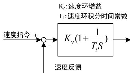
P018 可选择速度控制器结构，0 为 IP 调节器，100 为 PI 调节器，1~99 为 PDFF 调节器。P018 参数值偏大则系统具有高频率响应，参数值偏小则系统具有高刚度(抵抗偏差能力)，中等数值兼顾频率响应和刚度。
