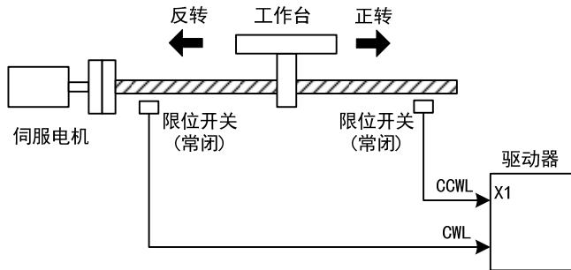
限位开关建议使用常闭接点，在安全范围内为闭合，超程为断开。连接到正转驱动禁止(CCWL)和反转驱动禁止(CWL)，通过参数P097也可设置为使用与忽略。设置为使用，则必须接入限位信号；设置为忽略，则不需要该信号。参数缺省值是CCWL和CWL都忽略，如果需要使用，必须修改参数P097。即使在超程状态下，仍允许通过输入反向指令退出超程状态。
