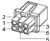
40电机带制动器电源插头
