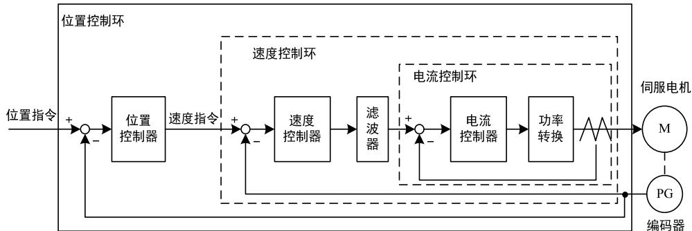
理论上，内层的控制回路频宽一定要高于外层，否则整个控制系统会不稳定而造成振动或是响应不佳，因此这三个控制回路频宽的关系如下：
