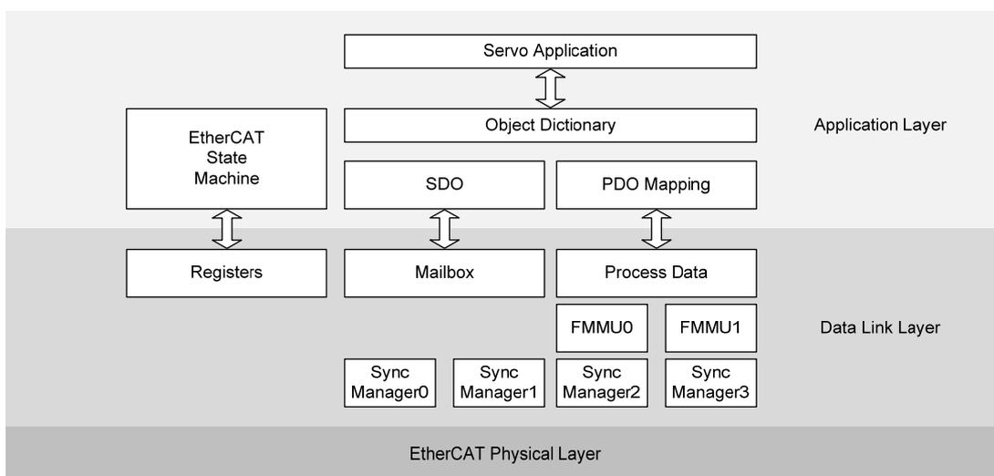
驱动器采用的是 CiA 402 驱动器的外形。应用阶层的 Object Dictionary 中包含应用数据及过程数据界面，还包括应用数据之间的 PDO 映射情报。
