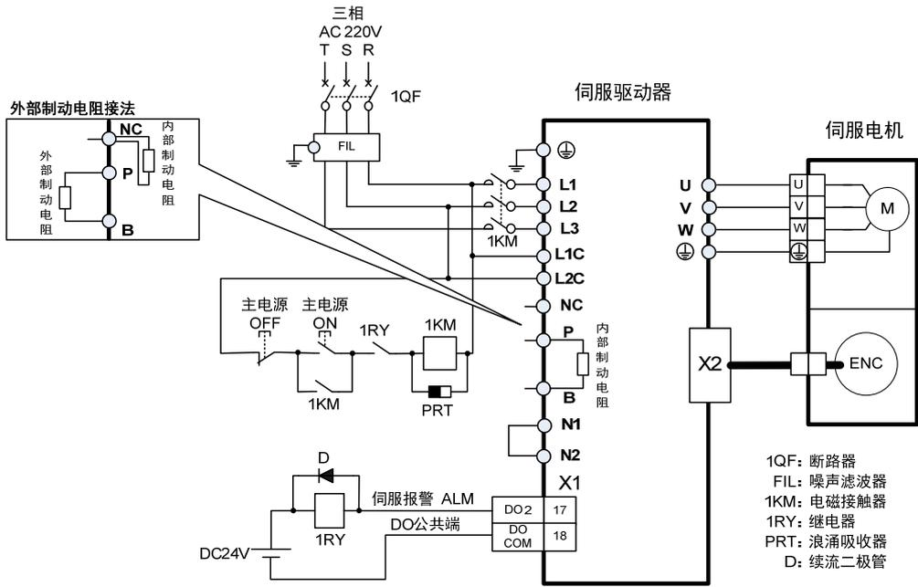
注：GL240 无内部制动电阻，需连接外部制动电阻使用。
