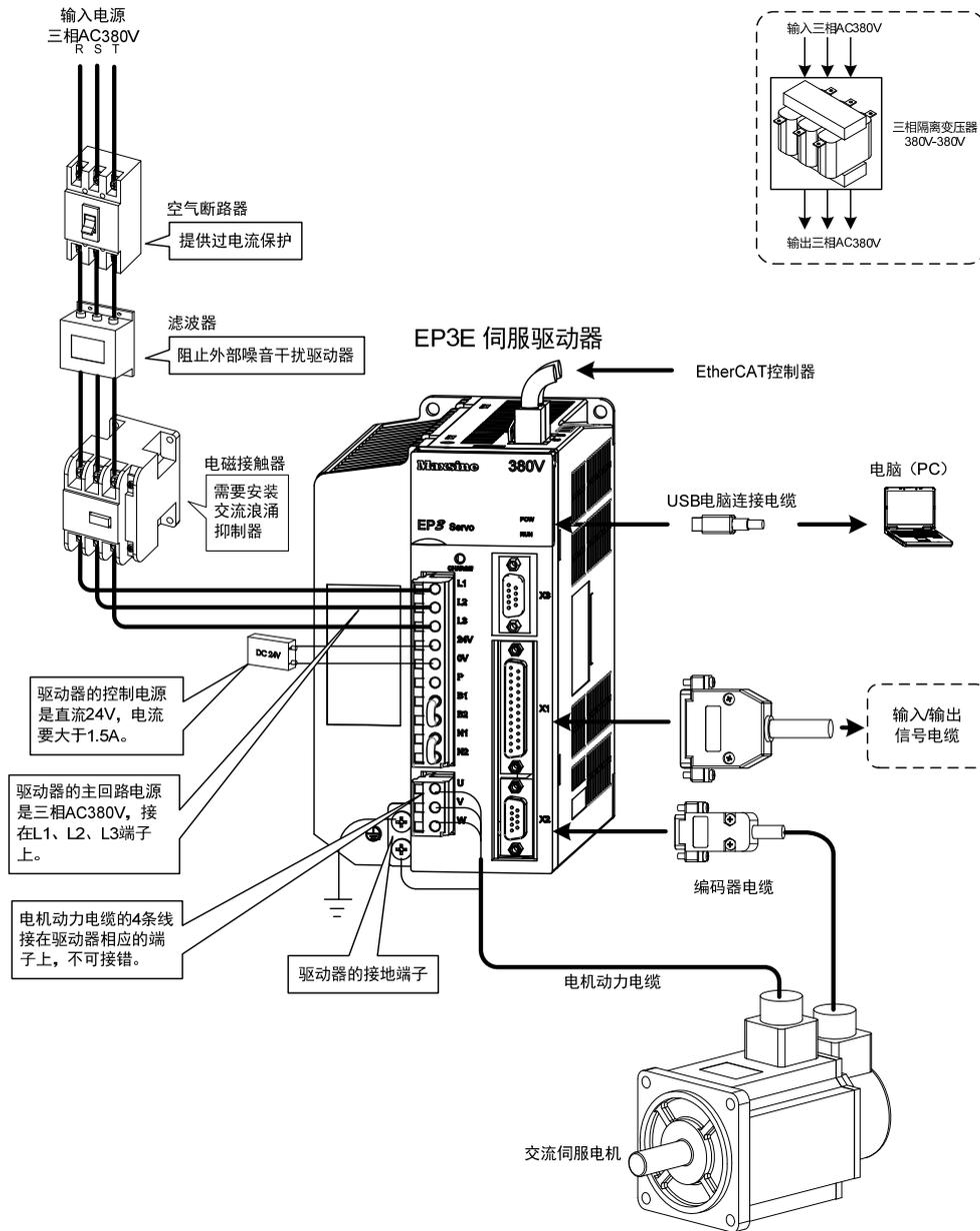
注：此接线方式仅适用 GH2A0、GH3A5 和 GH5A4，而 GH8A5、GH130、GH170、GH210 具体请参考 2.1.5 章节。
