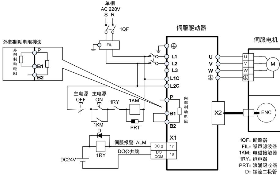
注：GL1A0 无内部制动电阻，一般不需要连接制动电阻。
